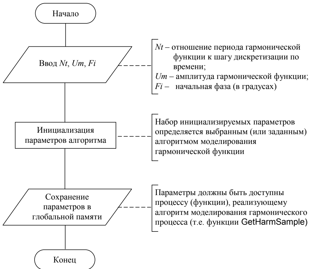
Рис. П.3.2. Блок-схема программы инициализации алгоритма моделирования гармонической функции (функция InitHarmRes из библиотеки mydll.dll )
