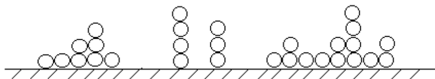
Рис. 1.6. Схема полимолекулярной адсорбции, принятой по теории БЭТ
